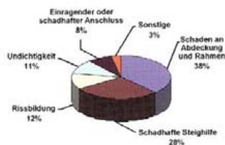
Bild 2: Schadensverteilung an Schächten [1] Fig. 2: Damage distribution in manholes [1]
