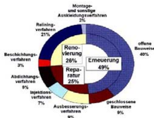
Bild 4: Verteilung der Sanierungsverfahren [1, 2]
