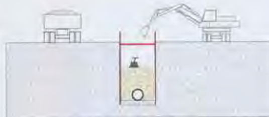
Beispiel Überschüttungsbedingungen A3, senkrechter Verbaue oder in den Fällen, in denen die Grabenwände nicht auf Dauer erhalten bleiben
