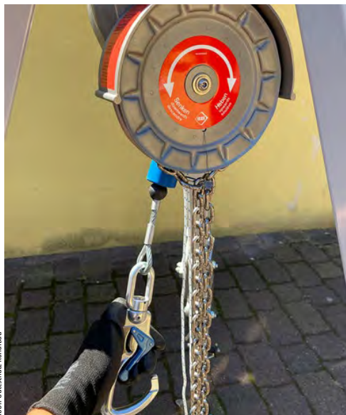
Abb. 1 – Fachgerecht (links): Eine Rettungshub-Funktion hängt an einem geeigneten Anschlagpunkt ist nur mit Haspelkettenantrieb möglich. Nicht fachgerecht (rechts): Der Anschlagpunkt ist nur für die Absturzsicherung geeignet, nicht für die Verwendung eines Höhensicherungsgerätes mit Kurbel zur Personenrettung.
