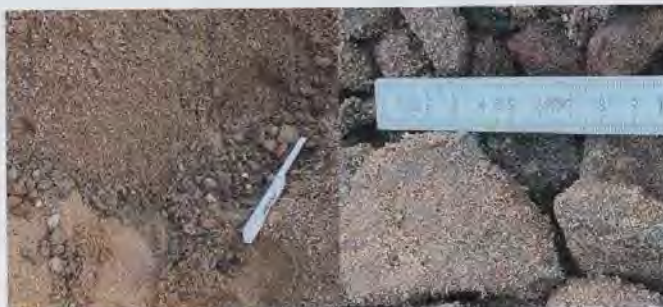
Bild 1 und Bild 2 : Material aus dem Schaufelseparator in der Leitungszone (l.); Überkorn in der Leitungszone (r.)
