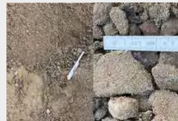
Bild 2 Material aus dem Schaufelseparator in der Leitungszone (l.); Überkorn in der Leitungszone (r.).
