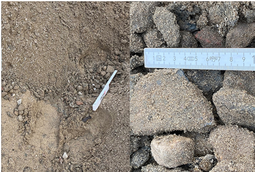
Material aus dem Schaufelseparator in der Leitungszone (l.); Überskorn in der Leitungszone (r.).
