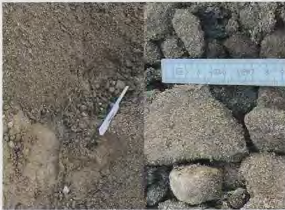
Material aus dem Schaufelseparator in der Leitungszone (l.); Überkorn in der Leitungszone (r.).
